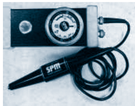
Sonde indicatrice SPM Pulse-mètre de chocs SPM avec sonde indicatrice
